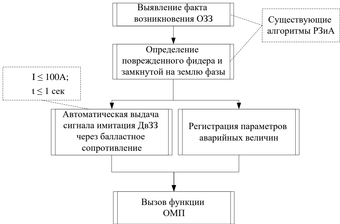
Рисунок 3.2 – Структурная схема алгоритма определения места повреждения при ОЗЗ
