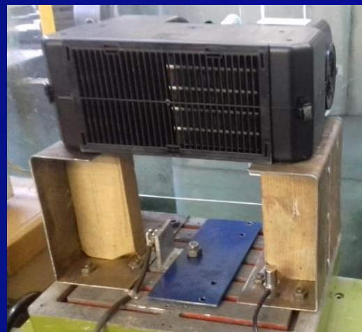
Натурные испытания на вибростенде
