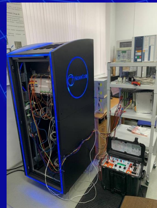
Киберфизический стенд с ПАК RTDS NovaCor
