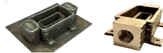
Пример детали, изготовленной по технологии WAAM
