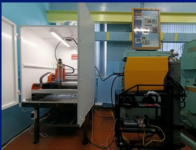
Комплекс для аддитивной электродуговой наплавки с интеллектуальной системой диагностики
