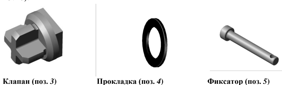
Рис. 13.10. Детали, входящие в изделие «Клапан предохранительный»
