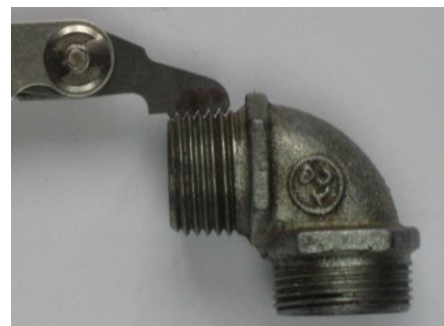
Рис. 10.8. Измерение шага резьбы (числа витков)
