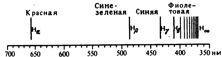
Рис. 7. Линии видимого спектра атомного водорода (серия Бальмера)
