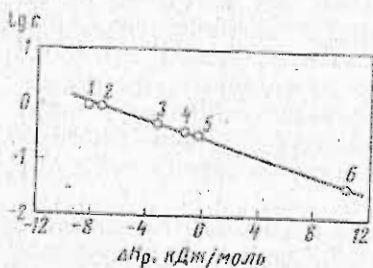
Рис. 2.18. Взаимосвязь между теплотой растворения \Delta H_p и растворимостью газов c в \text{C}_2\text{H}_5\text{OH} при 25^\circ\text{C} : 1 — He; 2 — Ne; 3 — \text{N}_2 ; 4 — CO; 5 — Ar; 6 — \text{CO}_2
