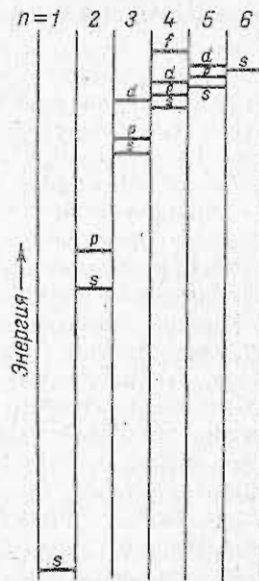
Рис. 1.10. Энергетические уровни в многоэлектронных атомах (примерная схема)
