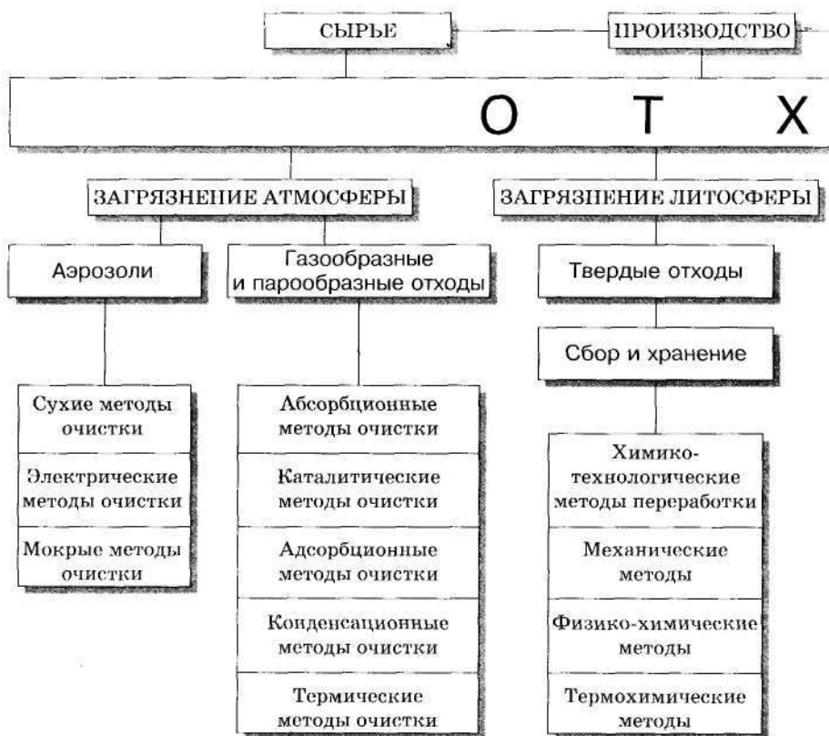
Рис. 10.20. Методы обезвреживания и переработки газообразных, ЖИДКЕ
