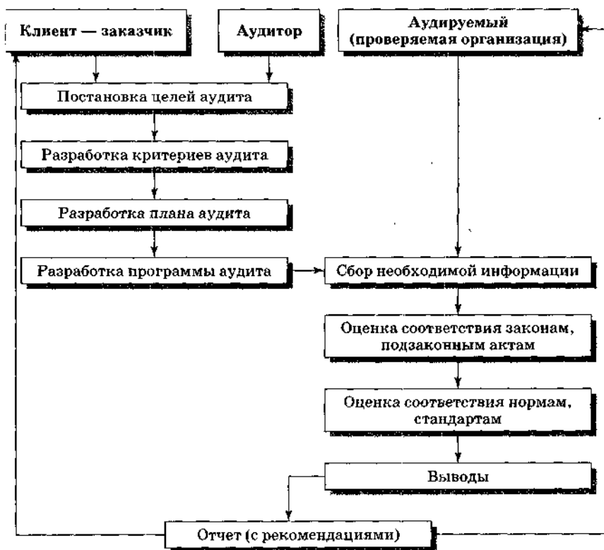
Рис. 10.18. Последовательность этапов и схема взаимодействия участников экологического аудита (по Е. В. Пащкову, Г. С. Фомину, Д. В. Красному)
