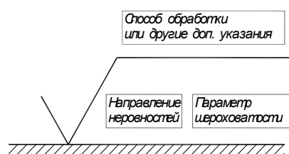
Рис. 12. Структура условного обозначения шероховатости
