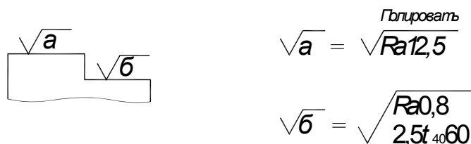
Рис. 8.3. Упрощенное обозначение шероховатости
