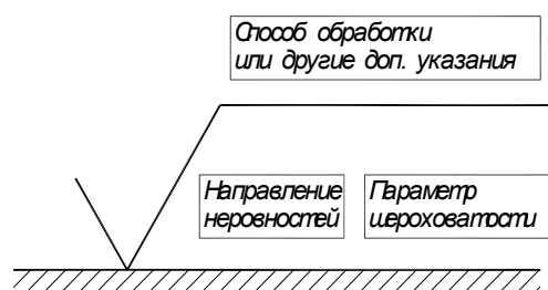
Рис. 8.2. Структура условного обозначения шероховатости
