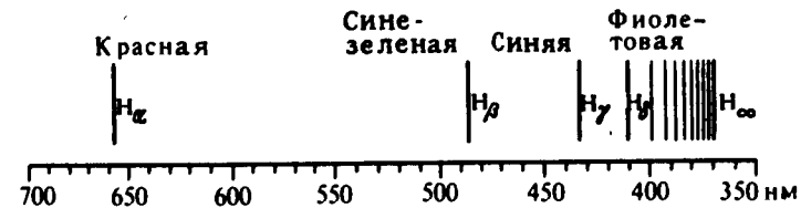
Рис. 7. Линии видимого спектра атомного водорода (серия Бальмера)
