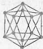
Рис. 3.8. Структура кристаллического бора Решетка состоит из икосаэдров [B 12 ], к.ч. 5, d(\text{B}-\text{B}) = 194 пм
