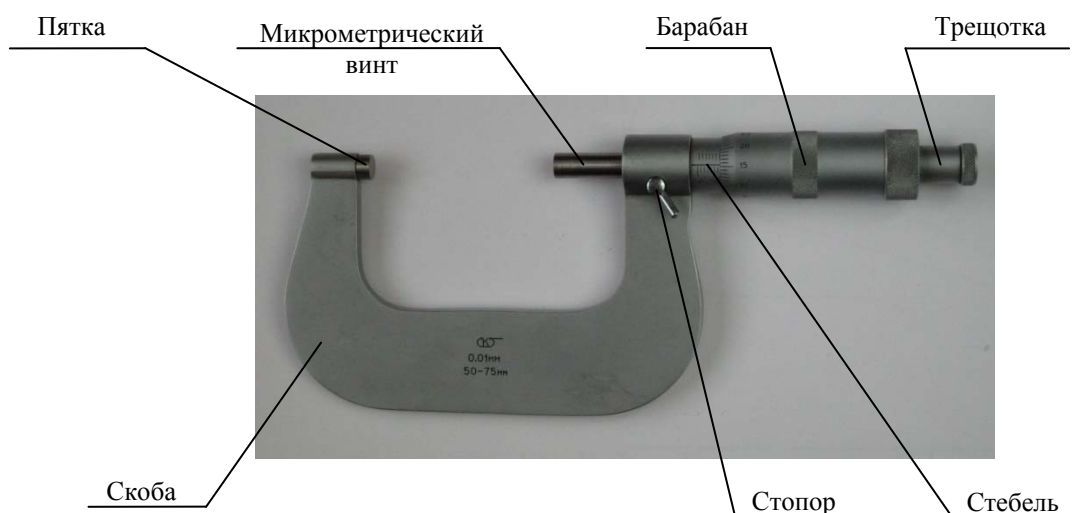
Рис. 10.5. Микрометр
