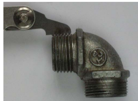
Рис. 10.8. Измерение шага резьбы (числа витков)
