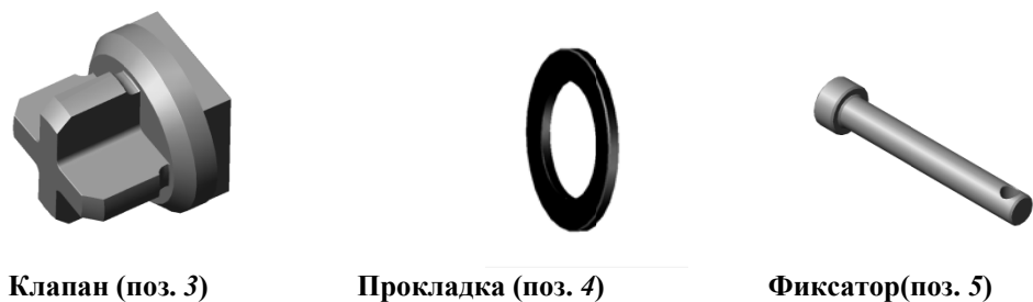
Рис. 13.10. Детали, входящие в изделие «Клапан предохранительный»
