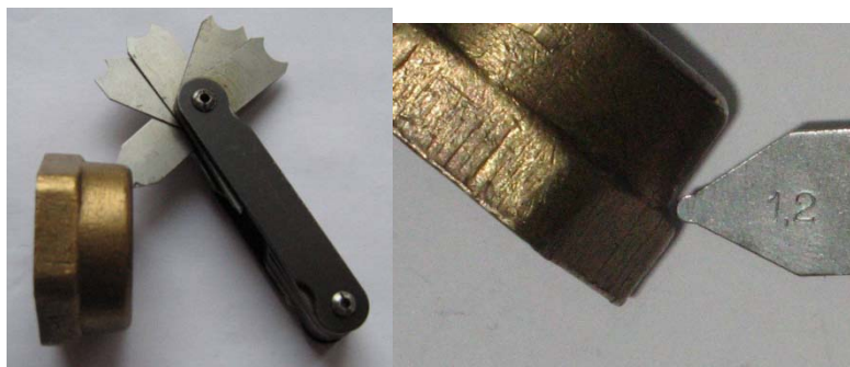
Рис. 10.7. Измерение радиусов скругления
