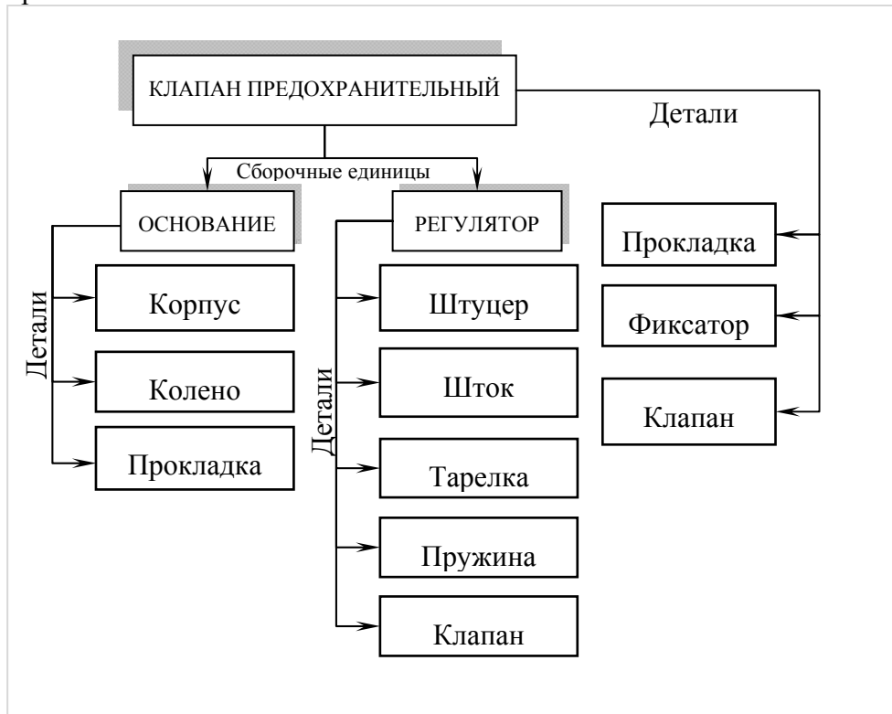
Рис. 13.11. Структура изделия «Клапан предохранительный»
