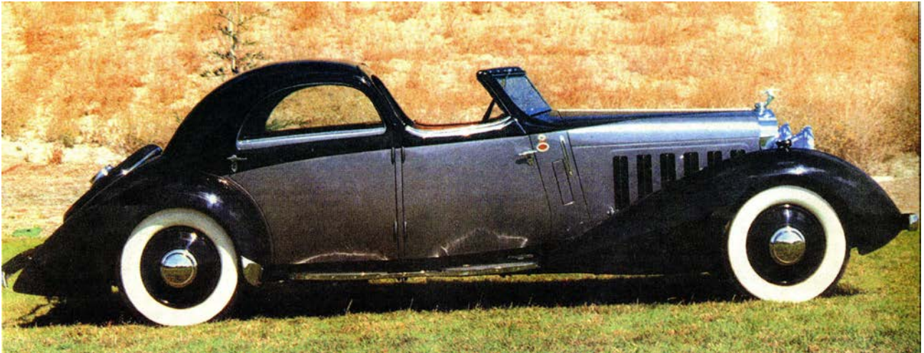
Рис. П.4.7. Испано-Сюиза (Hispano-Suiza): двигатель с рабочим объемом 12,5 л, рядный восьмицилиндровый верхнеклапанный 360 л.с.; максимальная скорость 170 км/ч, 1935 г., Франция
