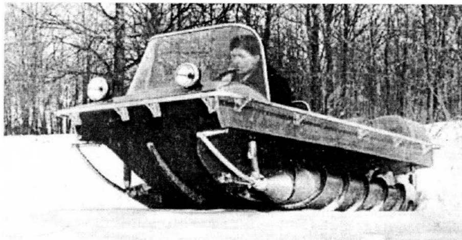
Рис. 40. Испытания созданного в лаборатории АМФ легкого снегоболотохода с роторно-винтовым движителем
