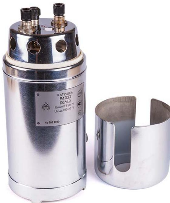
**Рис. 1. Общий вид меры электрического сопротивления однозначной**
