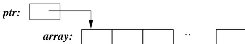
Между именем массива и указателем, выступающим в роли имени массива, существует важное различие. Указатель – это переменная, поэтому допустима операция изменения ее значения: *ptr=array* или *ptr++*. Но имя массива не является переменной, и записи типа *array =ptr* или *array++* ошибочны.
