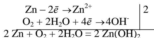
**Пример 19.** Цинковая и железная пластины помещены в водный раствор NaCl (аналог морской воды) и подсоединены к внешнему источнику постоянного тока: цинковая - к (-), а железная к (+) полюсу. Какая из пластин защищена от коррозии? Запишите уравнения коррозионного процесса.
