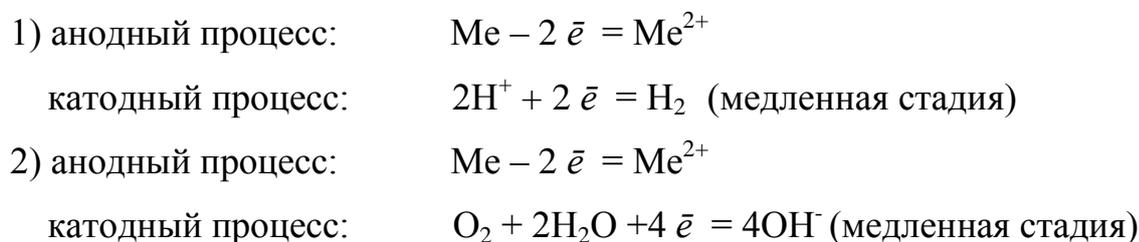
Коррозия с водородной деполяризацией наблюдается в кислых средах, где содержание  $H^+$  велико ( $pH \leq 6$ ); при большем  $pH$ , коррозия протекает с кислородной деполяризацией.
