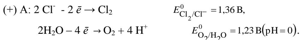
Согласно величинам стандартных электродных потенциалов на аноде должен выделяться кислород. В действительности, из-за высокого перенапряжения кислорода на электроде выделяется хлор. Величина перенапряжения зависит от материала, из которого изготовлен электрод. Для графита перенапряжение кислорода составляет 1,17 В при плотности тока равной  $1 \text{ а/см}^2$ , что повышает потенциал окисления воды до 2,4 В.
