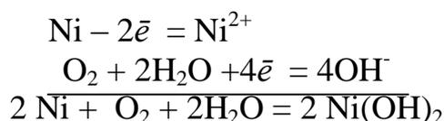
б) никель в водном растворе  $\text{NH}_4\text{OH}$  будет корродировать, так как молекулы  $\text{NH}_3$ , связывая ионы  $\text{Ni}^{2+}$  в слабодиссоциированные комплексные ионы, смещают потенциал никеля (-0,25 В) в более отрицательную сторону до значений -0,49 В, т.е. металл становится активнее:
