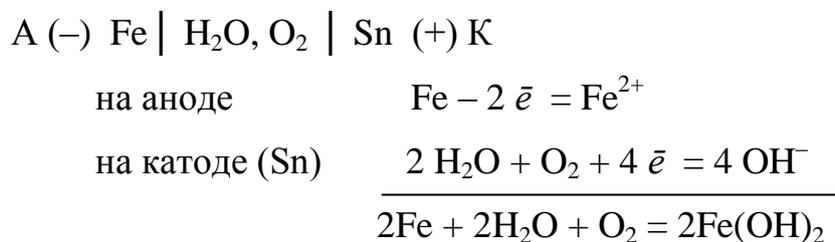
Таким образом, анодные покрытия наиболее эффективны, так как защищают основной металл даже в случае нарушения целостности, тогда как катодные покрытия защищают металл лишь механически.
