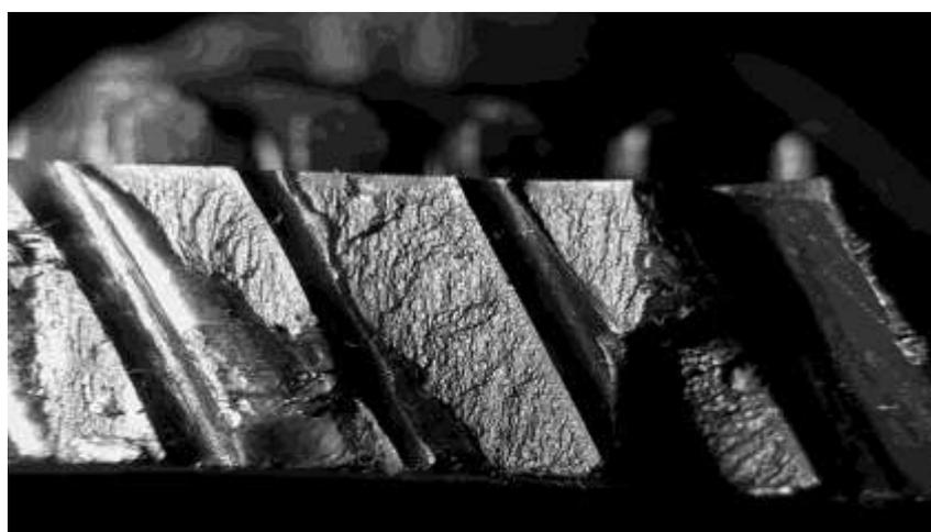
**Рис. 1. Усталостный излом зубьев ведомой шестерни**
