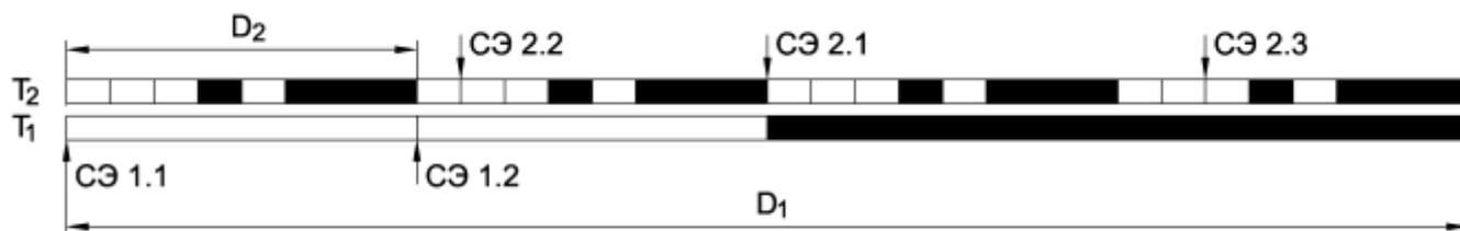
Рис. 2. Линейная развёртка пятиразрядной кодовой шкалы
