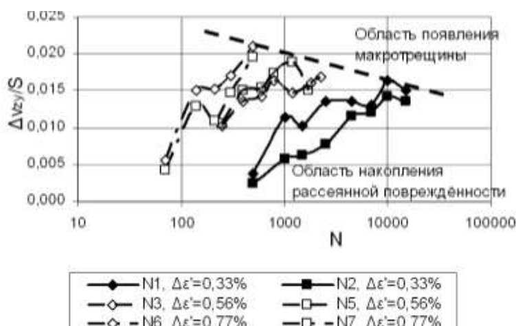
Рис. 6. Отношение изменения коэффициента Пуассона к параметру S в зависимости от количества циклов нагружения
