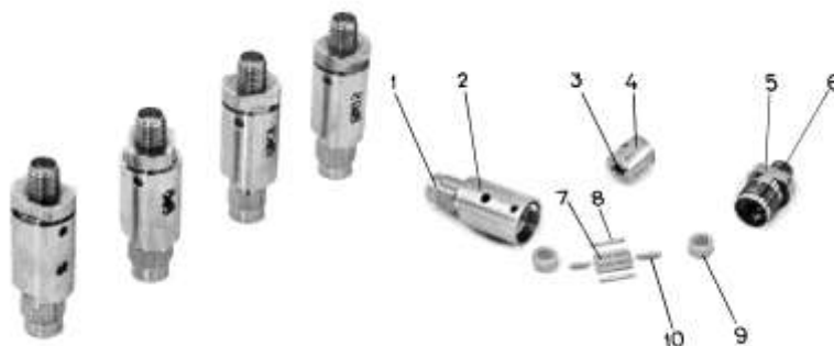
Рис. 13. Внешний вид и узлы attenuатора в коаксиальном тракте сечением 3,5/1,52 мм: 1, 6 – высокочастотные разъемы корпуса attenuатора; 2, 5 – свинчивающиеся части корпуса attenuатора; 3 – продольный паз, в который вставляется пластинчатый резистор 7 с пружинными контактами 8; 4 – втулка, внутренний диаметр которой равен 3,5 мм; 9 – удлинительное кольцо; 10 – электрод, надеваемый на центральный проводник резистора
