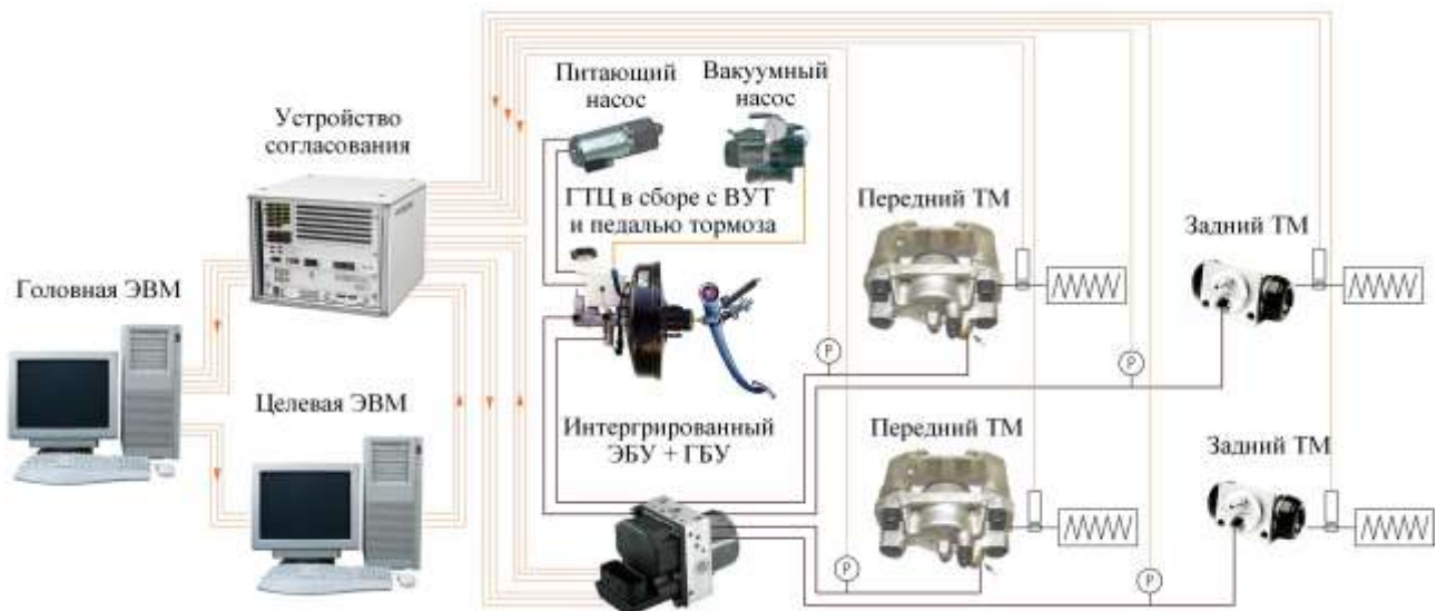
Рис. 4. Принципиальная схема ПАК для испытаний тормозных гидравлических систем с ЭКУ
