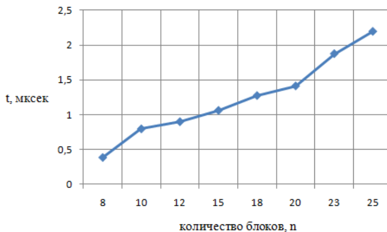
Рис. 4. Зависимость времени выполнения условного алгоритма (в микросекундах) от размера системы (в блоках)
