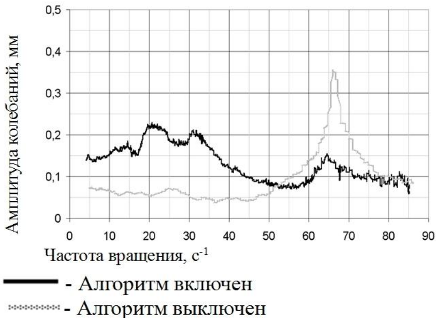
Рис. 7. Амплитуда колебаний ротора при вращении с включенным и выключенным законом
