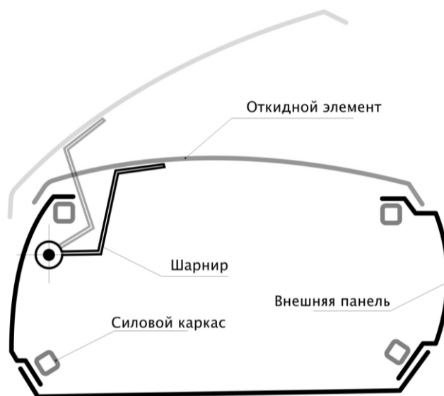
Рис. 1. Принципиальная схема каркасно-панельной конструкции
