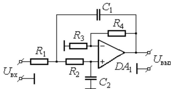
Рис. 5. Вариант ФНЧ второго порядка (структура Саллен-Ки)
