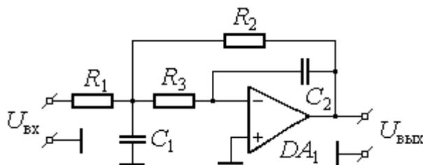
Рис. 4. Вариант ФНЧ второго порядка (структура Рауха)
