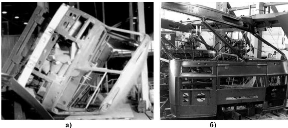
Рис. 1. Экспериментальные методы оценки пассивной безопасности автобусов:
