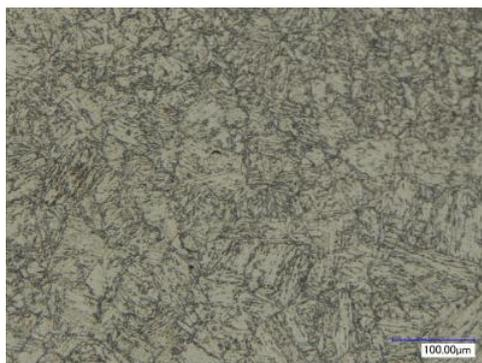
**Рис. 1. Микроструктура стали 15X2МФА, закалка 1000°C, высокий отпуск 700°C, воздух (10 ч), x500**
