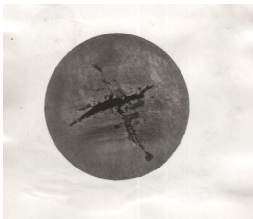
Рис. 1. Вид шлифа после травления, x100
