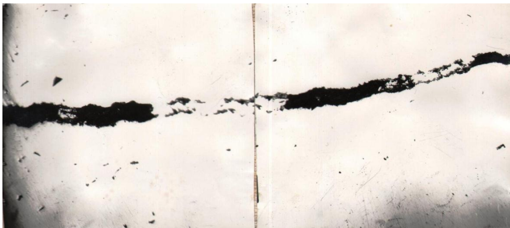
Рис. 3. Микроструктура нетравленого шлифа в районе трещины, x100
