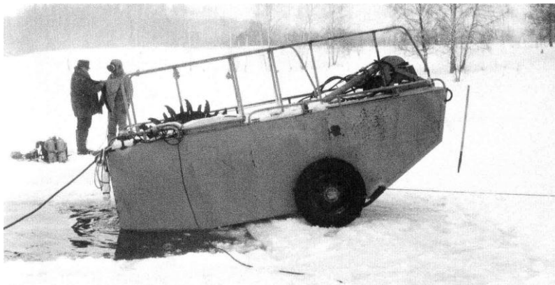
Рис. 3. Выход ЛФМП-1 на лед из майны с помощью собственной лебедки
