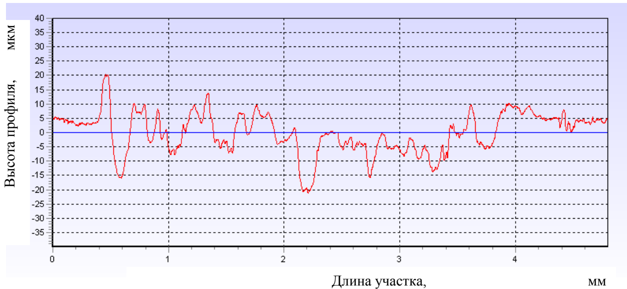
Рис. 13. Профилограмма поверхности контактной пары без сформированного оксидного покрытия после экспериментального исследования в расплаве свинца при T = 500^\circ\text{C} , термодинамической активности кислорода 10^0 , удельной нагрузке 12 \text{ кг/см}^2 , шероховатости поверхности Ra = 3,5
