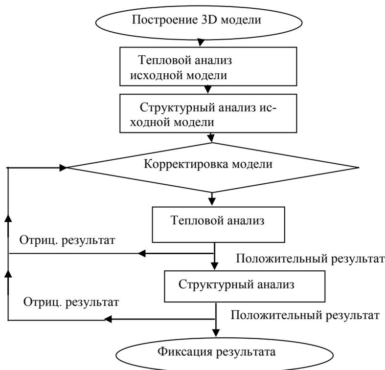
**Рис. 2. Упрощенная схема тепловой оптимизации ротора ТК**
