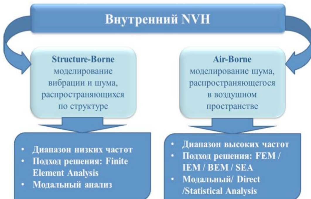
Рис. 1. Структура внутреннего NVH -анализа автомобиля
