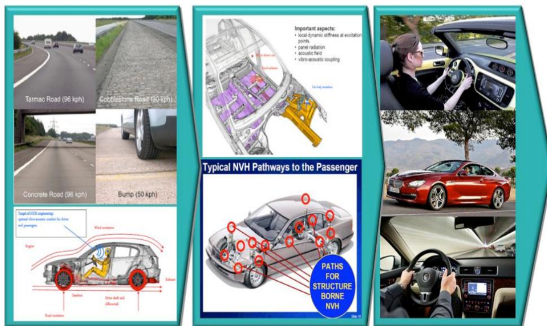
Рис. 4. Концепция «источник-путь-приемник» для виброакустического анализа автомобиля
