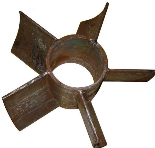
Рис. 6. Выпрямляющий аппарат (без чехловой трубы) после этапа испытаний при активности кислорода в свинце 10^{-5} \div 10^{-4}
