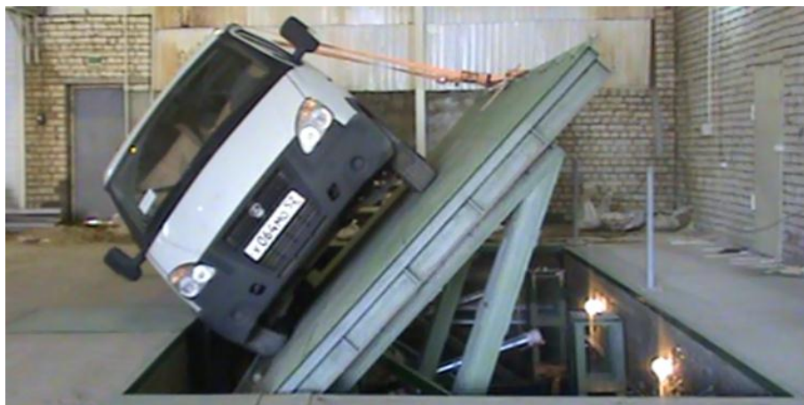
Рис. 2. Экспериментальные исследования статической устойчивости микроавтобуса
