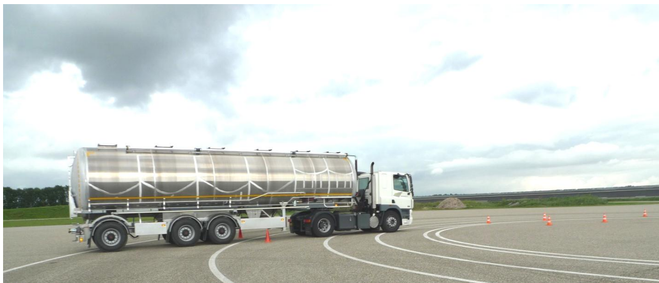
Рис. 10. Фрагмент дорожных испытаний «смена полосы движения (переставка)»
