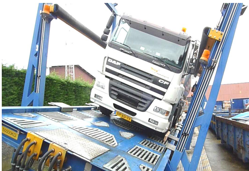
Рис. 7. Фрагмент натуральных испытаний по оценке статической поперечной устойчивости
