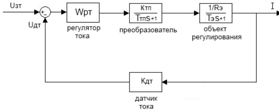
Рис. 2. Структурная схема контура тока ЭМП
