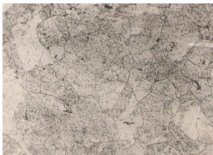
Рис. 2. Микроструктура стали после отпуска при температуре 620^{\circ}\text{C} без предварительной закалки. Увеличение \times 340 S_{cp} 109-138 \text{мкм}^2
