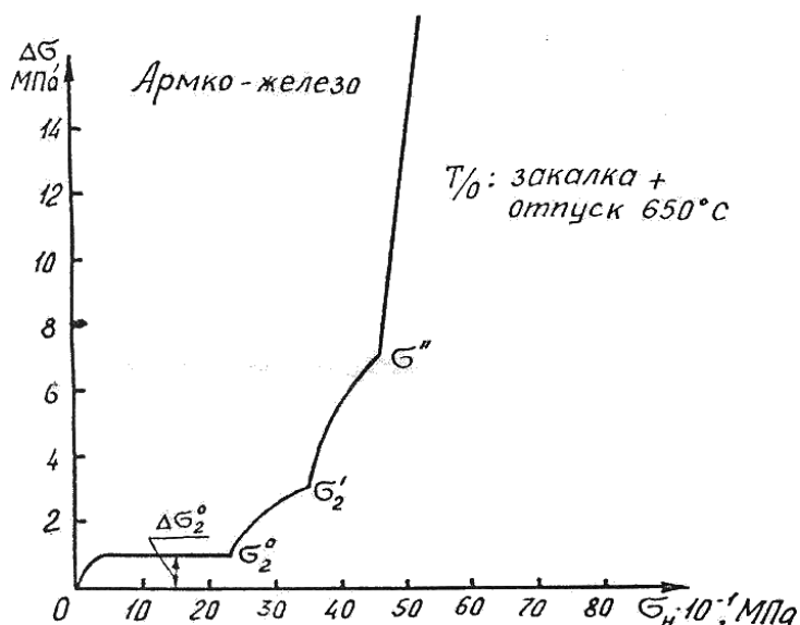
Рис. 4. Нагружение образца из армко-железа
