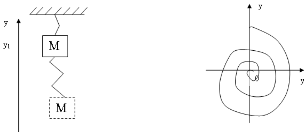
Рис. 2. Фазовый портрет линейного гармонического осциллятора с учетом трения
