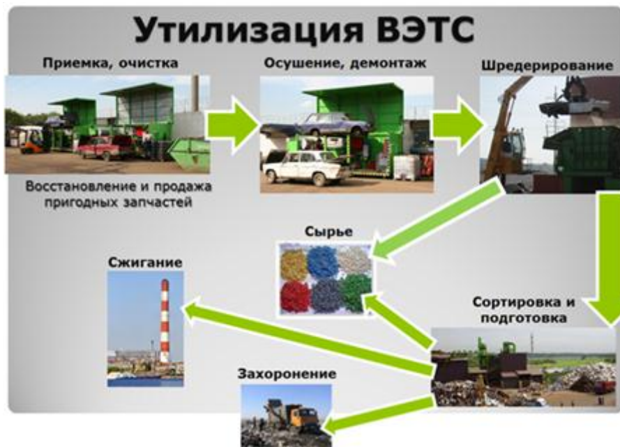
Рис. 1. Обобщенная схема технологического процесса утилизации ВЭТС
