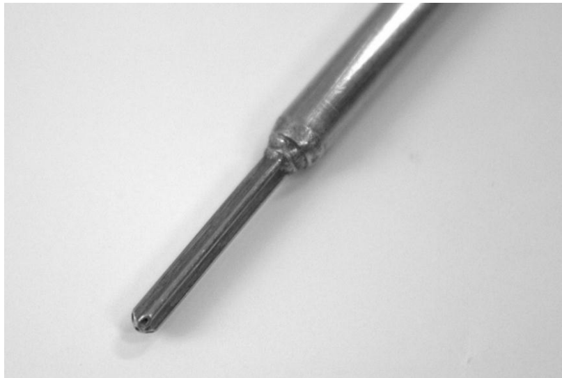
Рис. 3. Чувствительная часть пятиканального пневмометрического зонда
