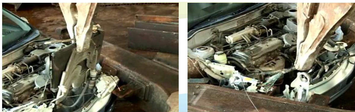
Рис. 4. Разрывание конструктивных элементов автомобиля при помощи универсального манипулятора на предприятии в Японии
