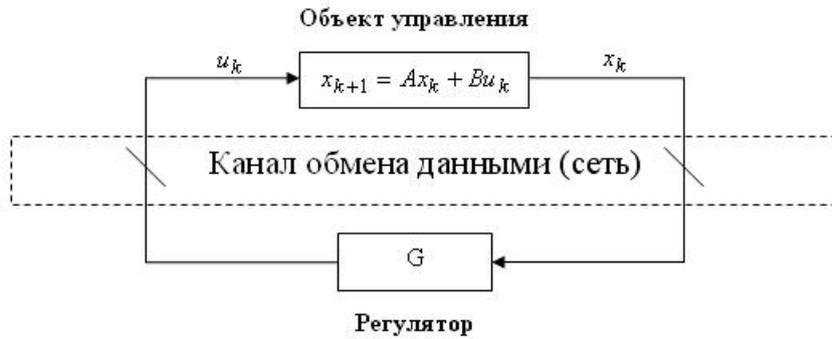
Рис. 2. Схема сетевой системы управления
