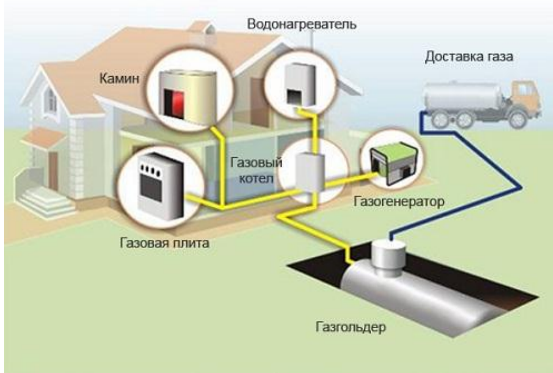
Рис. 1. Условная схема системы автономной газификации дома
