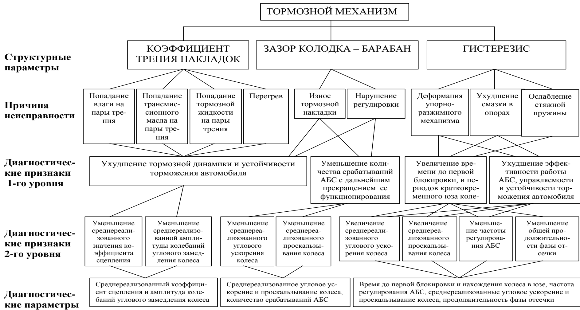
Рис. 5. Структурно-следственная схема для диагностирования тормозного механизма автомобиля с пневматической тормозной системой, оснащенной АБС
