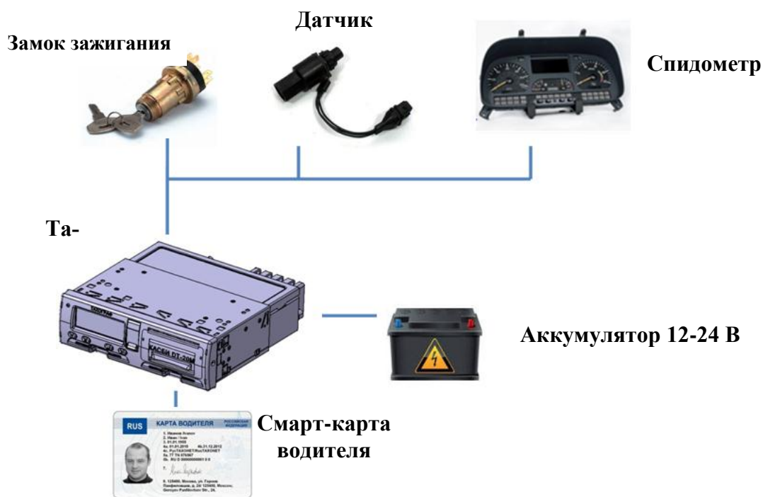
Рис. 3. Принцип работы тахографа
