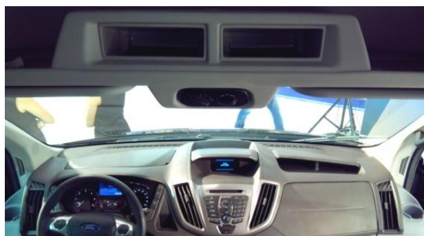
Рис. 5. Место размещения тахографа Ford Transit
