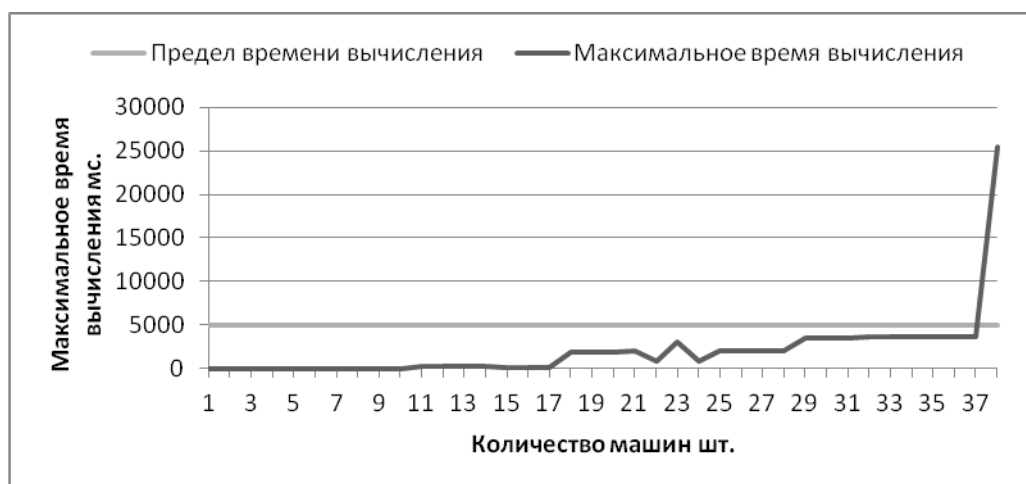
Рис. 5. Диаграмма зависимости максимального времени вычисления промежуточного решения от количества машин на графе
