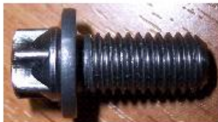
Рис. 1. Изделие болт М8 типа «TORX» из стали 20Г2Р
