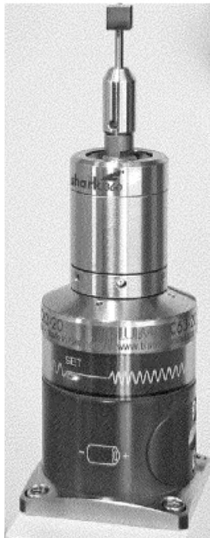
Рис. 1. Контактный датчик TC63-20 со встроенным источником питания
