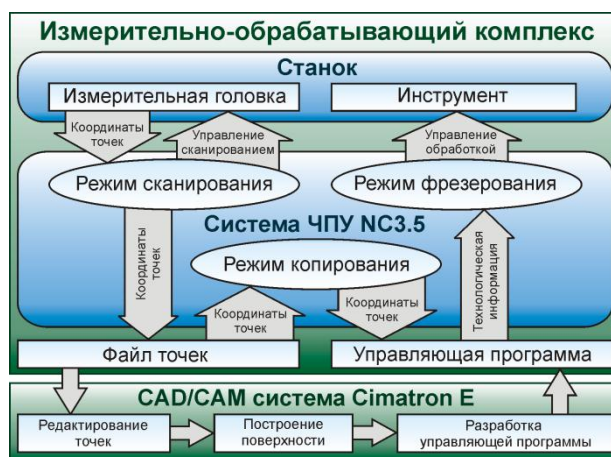
Рис. 3. Схема работы математического обеспечения СПУ NC 3.5
