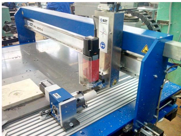
Рис. 1. Общий вид фрезерно-гравировального станка BZT-PFU-2015 PX-G с поворотным столом
