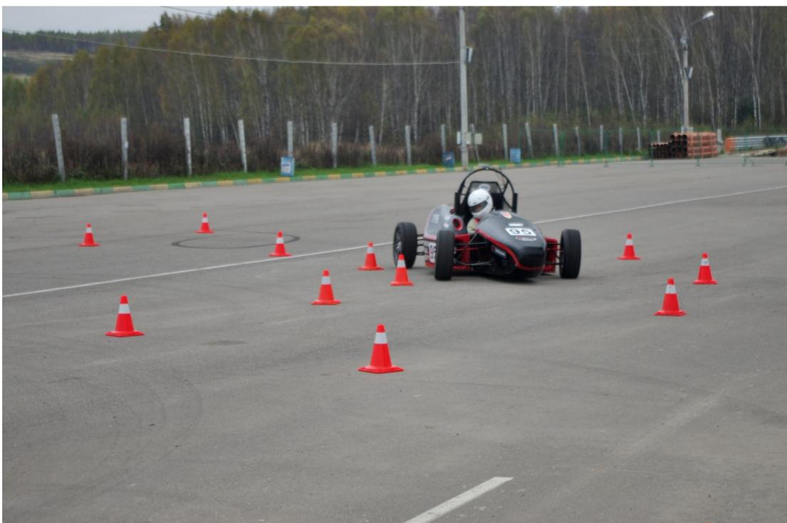
Рис. 5. Натурное испытание «движение по траектории постоянной кривизны»
