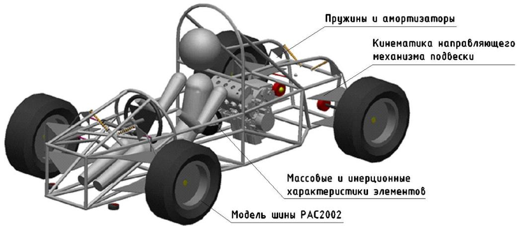
Рис. 3. Схема модели спортивного автомобиля класса «Formula Student»
