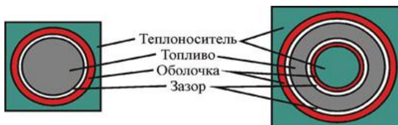
Рис. 1. Конструкция кольцевого и стержневого ТВЭЛ
