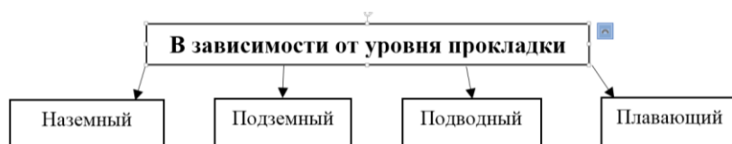
Рис. 1. Классификация трубопроводов в зависимости от уровня прокладки
