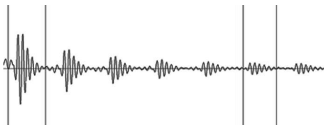
Рис. 3. Осциллограмма принятых акустических импульсов с приемлемым соотношением «сигнал/шум»
