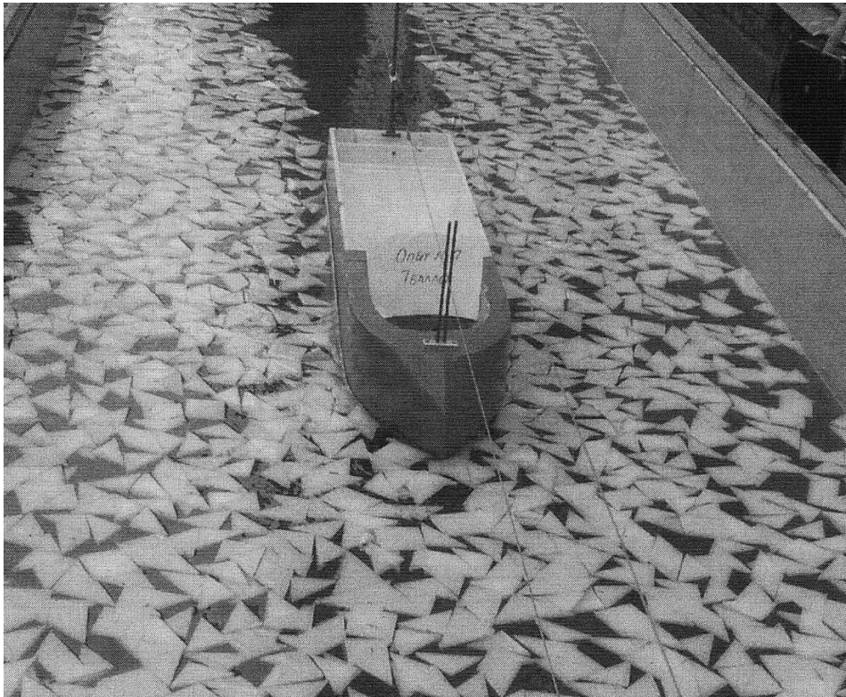
Рис. 3. Фрагмент испытаний во льду сплоченностью 8 баллов
