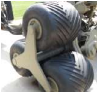
Планетарно-колесный движитель: самоходная гаубица М101 и машина «Terrastar» фирмы Lockheed Ground Vehicle Systems
