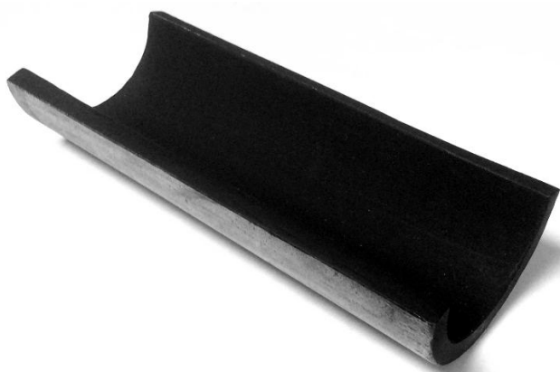
Рис. 5. Образец - труба Ø 63×6 мм из стали марки 12X18H10T
