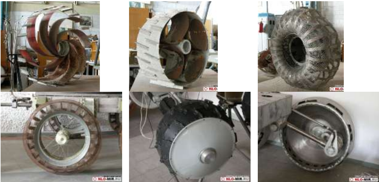
Полусферические полые колеса изобретателя Elie P. Aghnides
