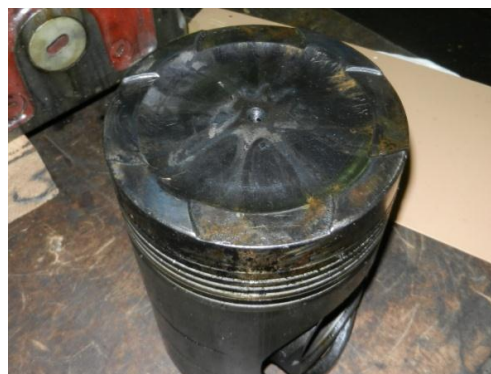
Рис. 7. Состояние деталей цилиндропоршневой группы двигателя 8ЧН 22/28 с базовым (а) и оптимизированным (б) рабочими процессами
