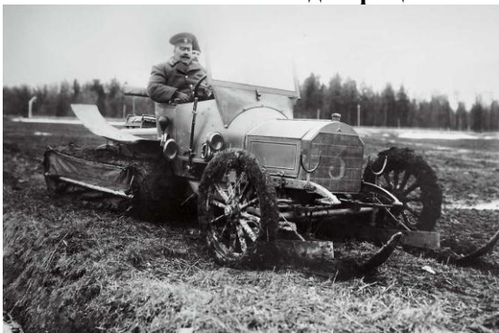
Рис. 48. Испытания автосаней Кегресса на базе «Руссо-Балта» 27 февраля 1915 года. Сзади прицеплены санки с живым «балластом»
