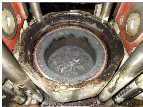
Рис. 7. Состояние деталей цилиндропоршневой группы двигателя 8ЧН 22/28 с базовым (а) и оптимизированным (б) рабочими процессами
