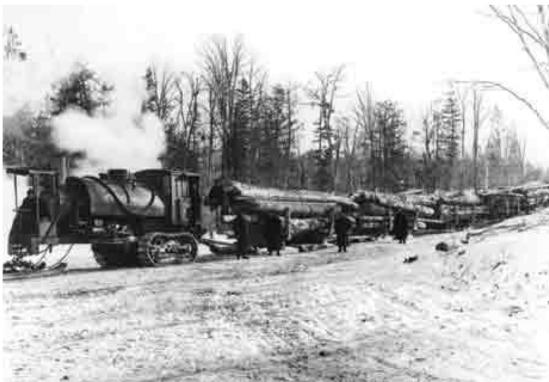
Рис. 23. Паровой снегоходный поезд на базе трактора «Lombard Log Hauler» (фото 1914 г.)
