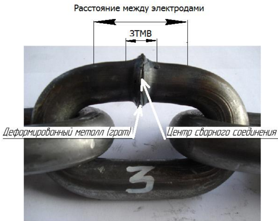
Рис. 6. Сваренное звено цепи 20x80 без обрезки грата
